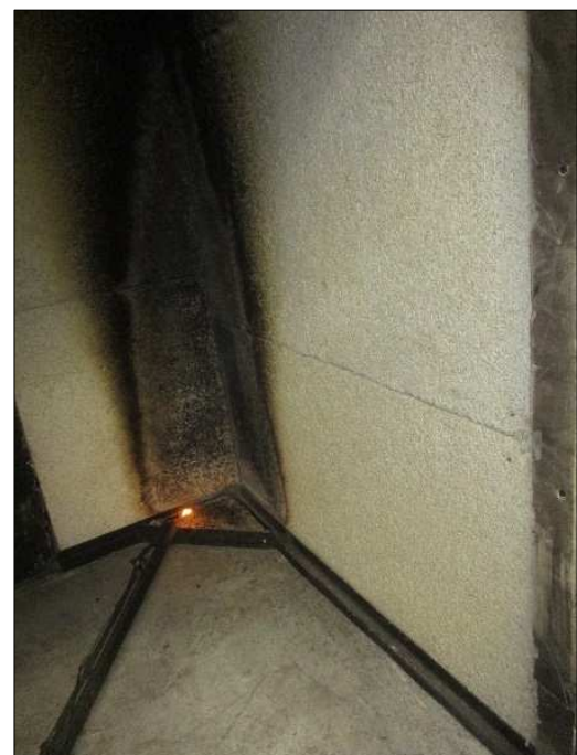
Vista totale del bordo esterno verticale dell'ala lunga dopo la prova Total view of the vertical outer edge of the long wing after the test
