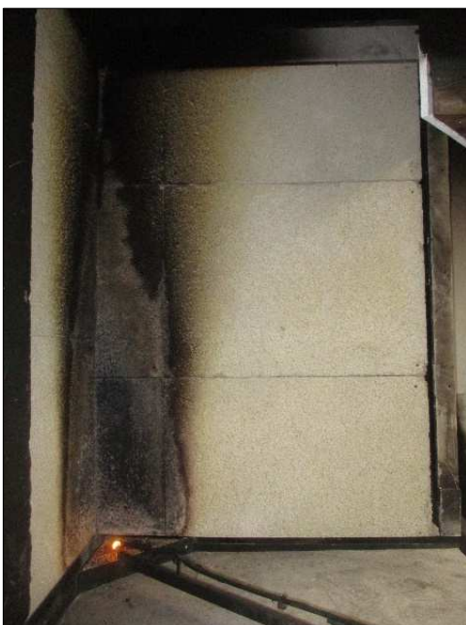
Vista totale della superficie esposta dell'ala lunga dopo la prova Total view of the exposed surface of the long wing after the test
